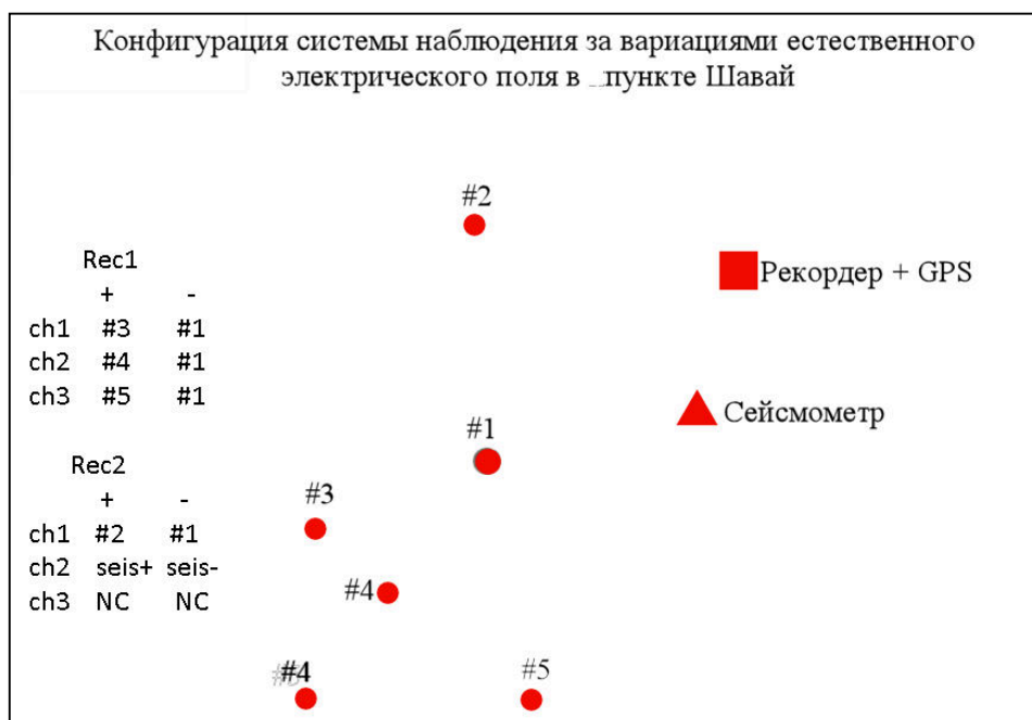
Рисунок 2.26 — Конфигурация системы наблюдения за вариациями естественного электрического поля в пункте Шавай
