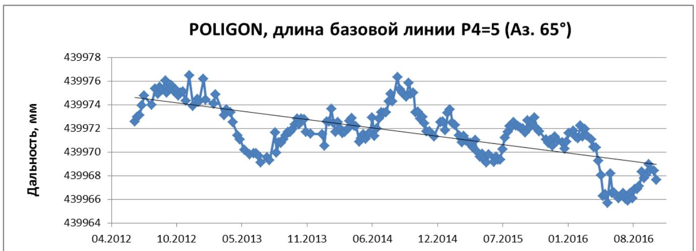
Рисунок 4.1-3 – Характер вариаций длины БЛ P4=5 без экстремальных значений (>5 мм относительно ближайших измерений). Скорость укорочения БЛ  $\approx -1.26$  мм/год, или скорость деформации  $\approx -2.87E-6$  год<sup>-1</sup>.
