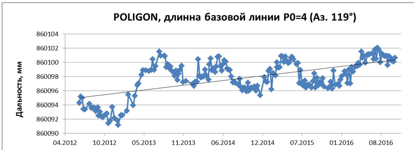
Рисунок 4.1-4 – Характер вариаций длины БЛ P0=4 без экстремальных значений. Скорость удлинения БЛ  $\approx 1.19$  мм/год, или скорость деформации  $\approx 1.38E-6$  год<sup>-1</sup>.
