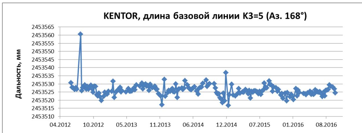
Рисунок 4.1-6 – Характер вариаций длин БЛ К3=5 на площадке KENTOR, с 06.06.2012 по 12.10.2016 проведено 187 циклов измерений.
